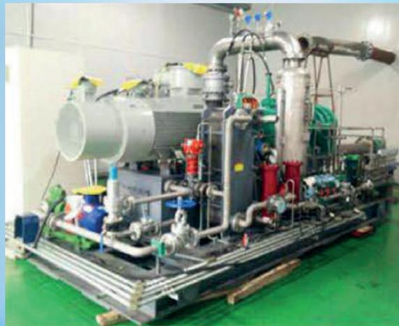
**Turbo Compressor Centrífugo**
