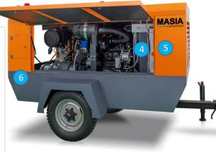
Tablero eléctrico diseñado con componentes alemanes, sellado para evitar el ingreso de polvo.
